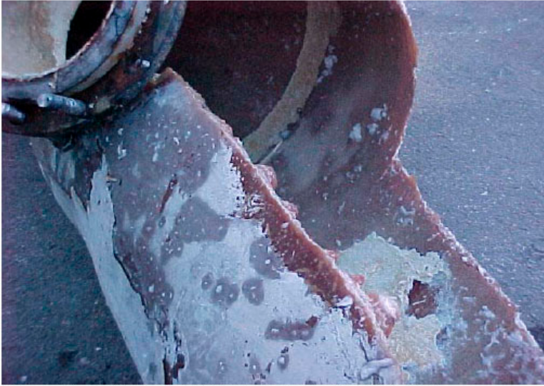
Bild 2. Knivskarp brottyta på ovasida DN 600 rör utgående från stutsanslutning DN 250
